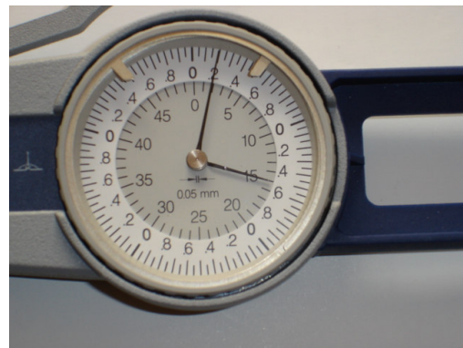
Ablesegenauigkeit 0,05 mm (Doppelzeiger-System)
